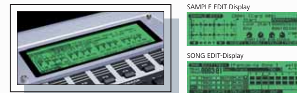
Das beleuchtete 240 x 64 Pixel-LCD bietet einen guten Überblick mit Symbol-basierter Kommunikation.
